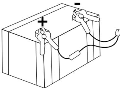
3. Вставьте другой конец адаптера «крокодилы» в выход устройства для запуска автомобильного аккумулятора 12В
